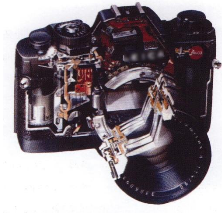
Resim 2.1: Fotoğraf makinesinin kesiti
